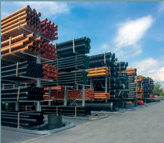
Műanyag csövek külső raktározása egy nagykereskedésben. Horganyzott karos állványrendszerek vezetősínekkal a négyirányú targoncához.
