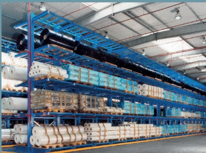
Karhidakkal felszerelt karos állványrendszerek nehéz műanyagfóliák tárolásához.
