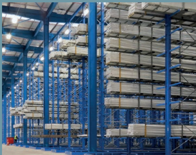
Karos állványrendszerrel felszerelt raktár, 13 500 mm magassággal és 13 raktárszinttel alumínium és műanyag profilokhoz, kazettákban tárolva.
