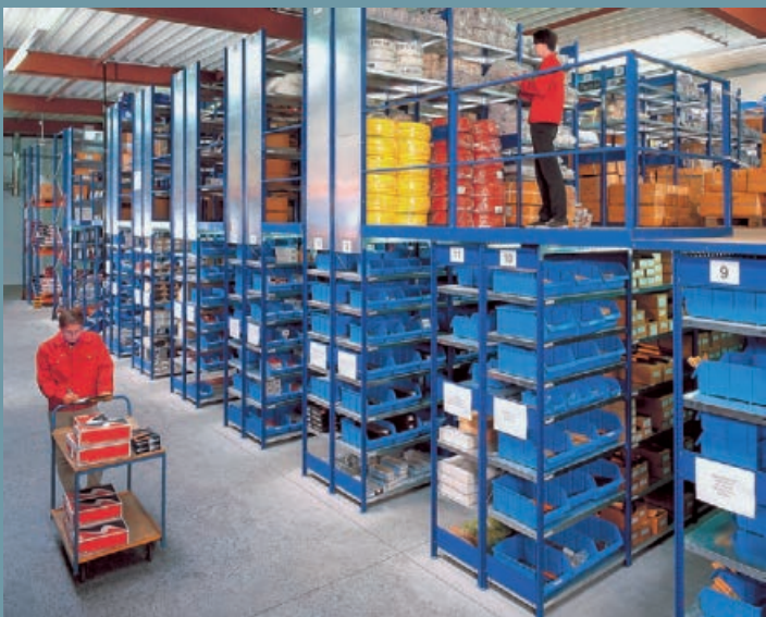
A teherautó alkatrésznaktárban vagy az értékesítési területen akár több emeletes rekeszes polcrendszerek biztosítják a jobb áttekinthetőséget és a kisebb cikkek gyorsabb megtalálását.
