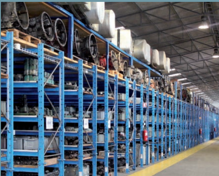
Robusztus raklappolcok kombinációja alkatrészek vagy apró cikkek tárolásához, a legfelső szint hajtóműveket vagy terjedelmes komponenseket szolgáló kiegészítő raktárhelyeként.
