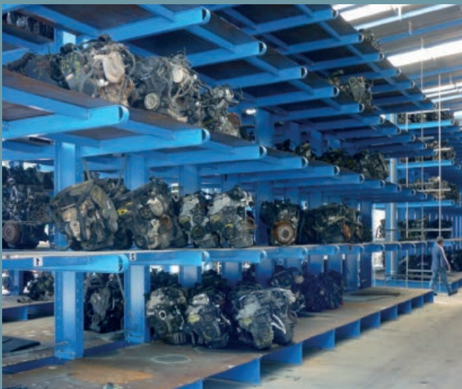
Motorok tárolása robusztus karos állványrendszereken. A karhidak használata következtében különböző méretek egy szinten való, nagyobb darabszámban történő tárolására nyílik lehetőség.
