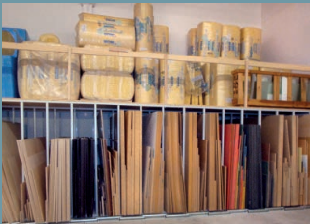
Forgácslapok álló tárolása a felső oldal kiegészítő tárolószintként való használatával.
