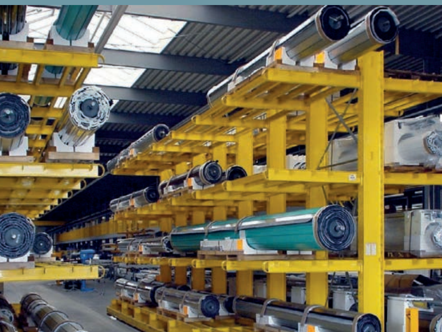
Készre gyártott gurulókapuk robusztus karos állványrendszerekben. Karak közötti, ún. karhidak különböző méretek tárolásához.
