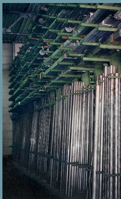
Csövek és rúdanyag függőleges, közvetlenül munkahelyen történő, osztályozott tárolása a könnyű elérhetőség érdekében.
