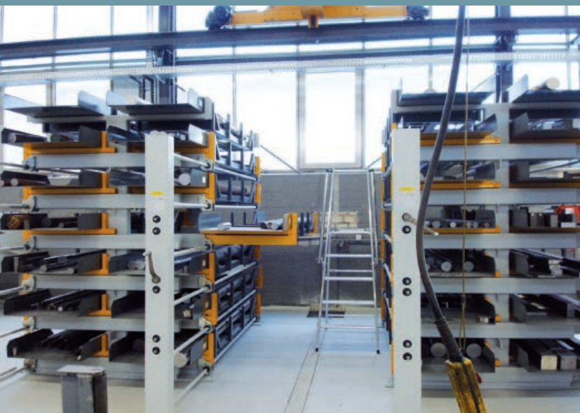
Teleszkópkarú állványrendszerek esetében egész tárolószintek húzhatók ki egy forgatható orsókön keresztül működő forgatókarral . Minimális folyosó szélességnél daruval elvégzett kezeléshez optimális.
