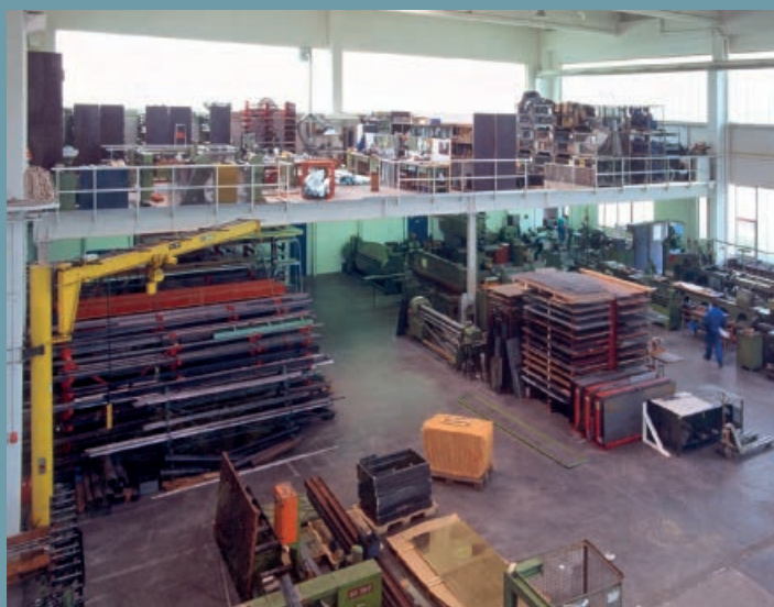
Kétszeres terület az acélfeldolgozásban. Fent és lent munkahelyek. Terhelés: 1000 kg/m 2
